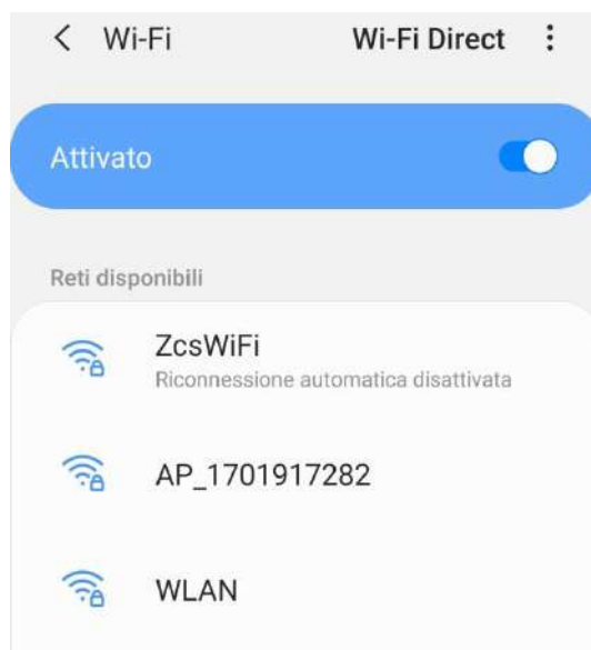
Figura 83 - Disattivazione della riconnessione automatica ad una rete
