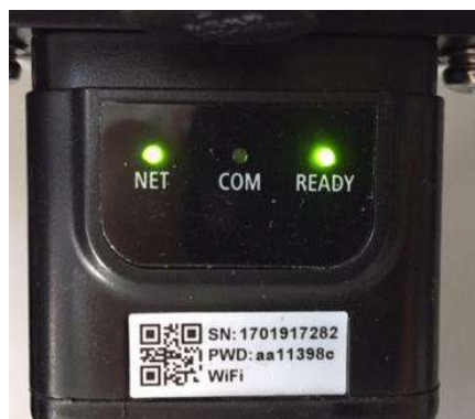
Figura 71 - Stato di comunicazione irregolare tra inverter e scheda
