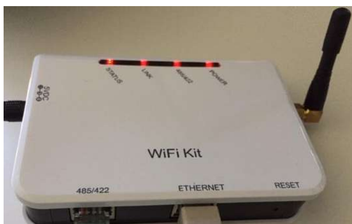
Figura 94 – Led che indicano la corretta configurazione del datalogger
