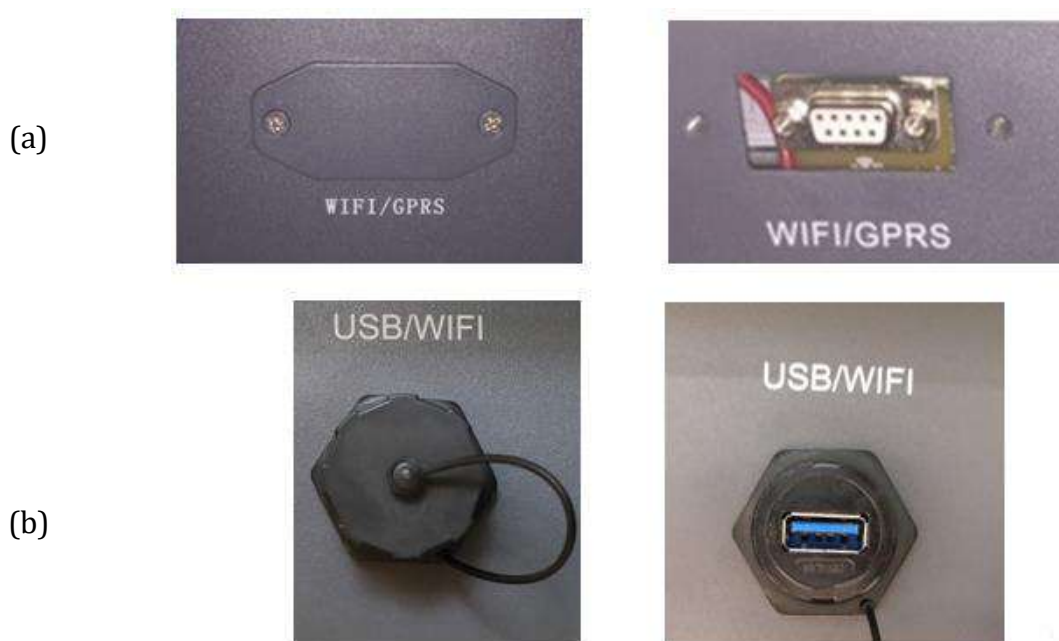
Figura 67 - Alloggiamento della scheda 4G
