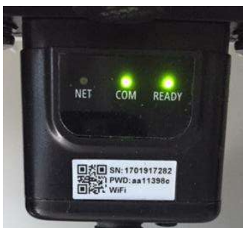
Figura 56 – Stato di comunicazione irregolare tra wifi e server remoto
