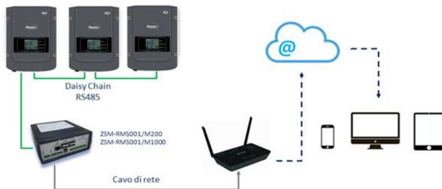
Figura 74 – Schema di funzionamento del datalogger ZSM-RMS001/M200 / ZSM-RMS001/M1000
