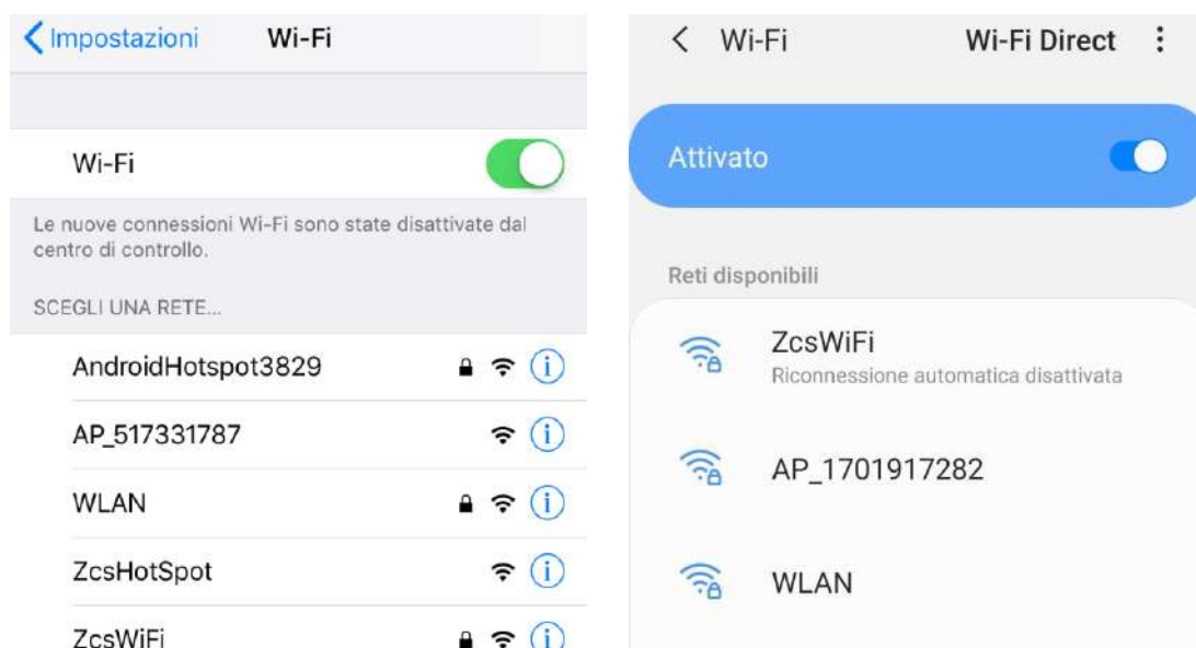
Figura 82 - Ricerca delle rete wifi su Smartphone iOS (a sinistra) e Android (a destra)
