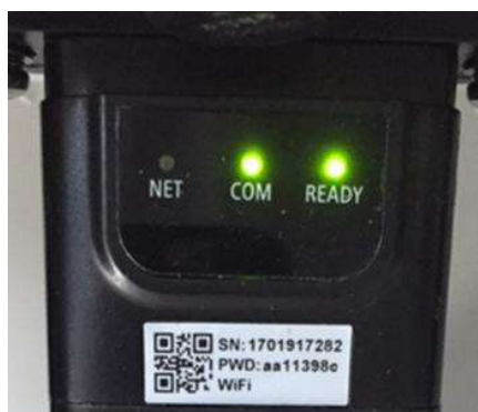
Figura 72 - Stato di comunicazione irregolare tra scheda e server remoto
