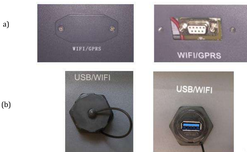
Figura 34 - Alloggiamento della scheda wifi esterna
