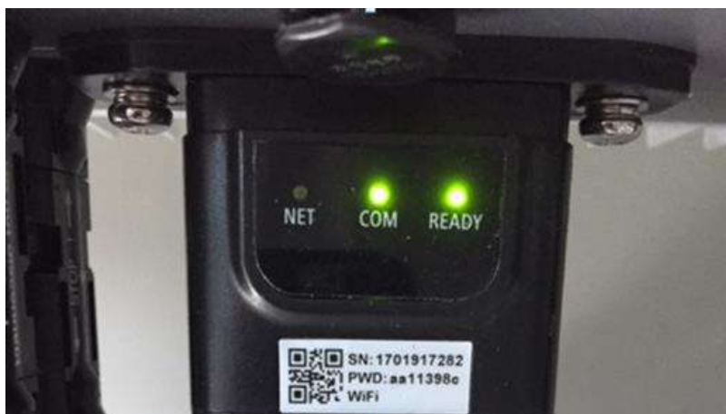
Figura 63 – Stato iniziale dei led
