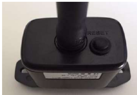
Figura 53 - Tasto di reset sulla scheda wifi
