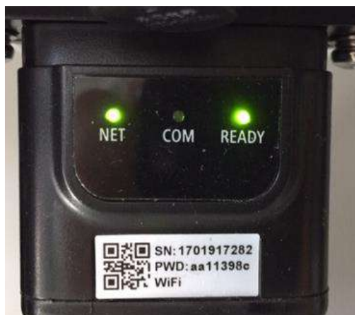
Figura 65 - Stato di comunicazione irregolare tra inverter e scheda
