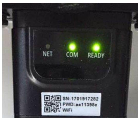
Figura 66 - Stato di comunicazione irregolare tra scheda e server remoto
