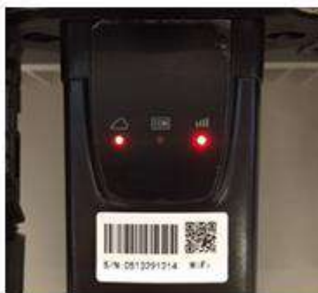
Figura 54 - Stato di comunicazione irregolare tra inverter e wifi
