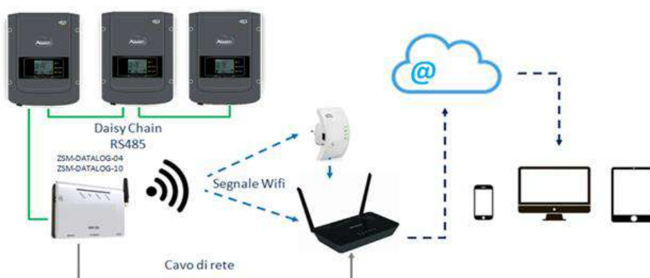
Figura 73 – Schema di connessione del datalogger ZSM-DATALOG-04 / ZSM-DATALOG-10
