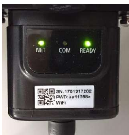
Figura 54 - Stato di comunicazione irregolare tra inverter e wifi
