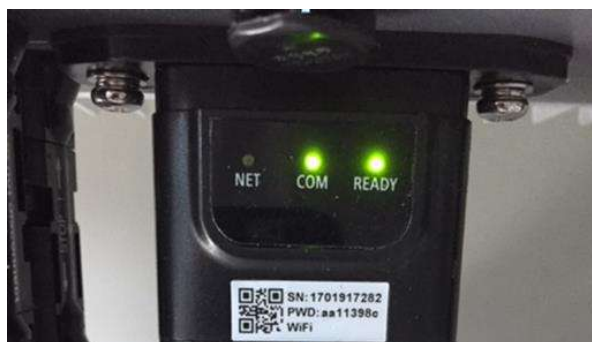
Figura 69 – Stato iniziale dei led
