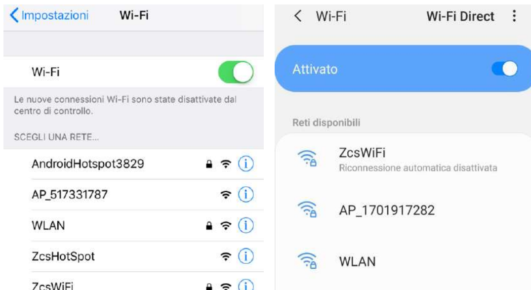
Figura 36 – Ricerca delle rete wifi su Smartphone iOS (a sinistra) e Android (a destra)
