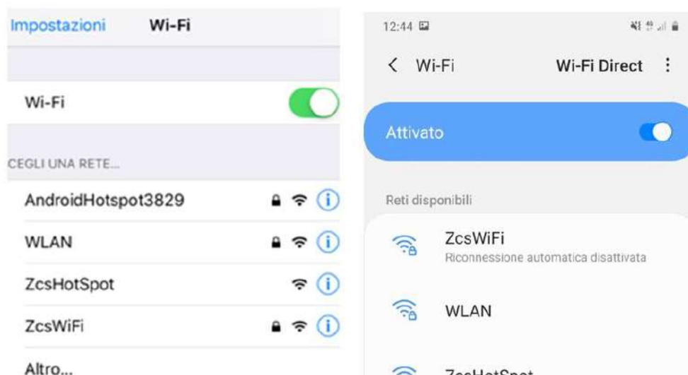
Figura 49 - Ricerca delle rete wifi su Smartphone (iOs e Android); l'Access Point della scheda wifi non è più visibile
