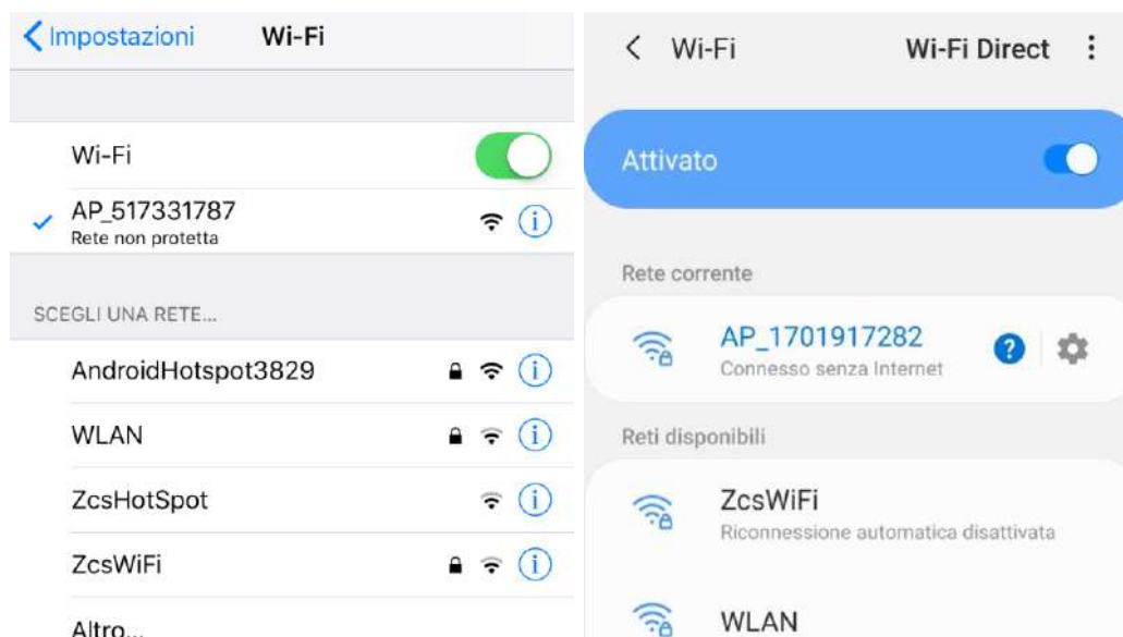
Figura 38 – Connessione all'Access Point della scheda wifi su Smartphone iOS (a sinistra) e Android (a destra)
