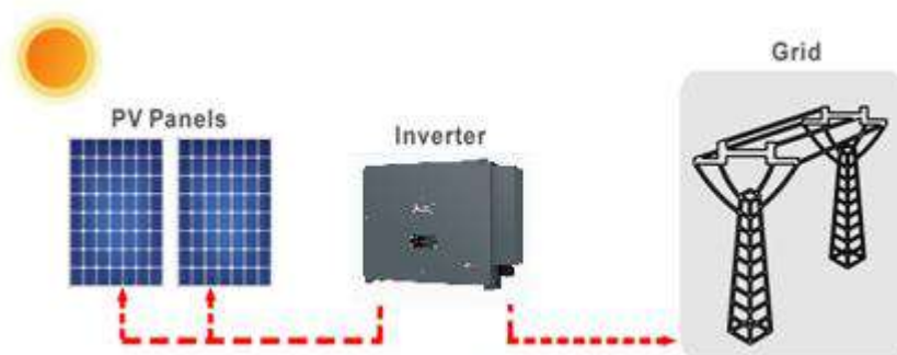
Figura 2 – Impianto fotovoltaico connesso in rete
