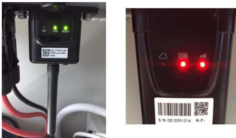
Figura 51 – Stato iniziale dei led
