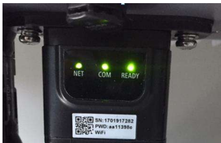
Figura 64 - Stato finale dei led
