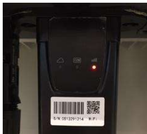
Figura 56 – Stato di comunicazione irregolare tra wifi e server remoto
