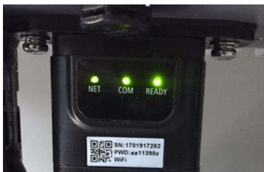
Figura 70 - Stato finale dei led
