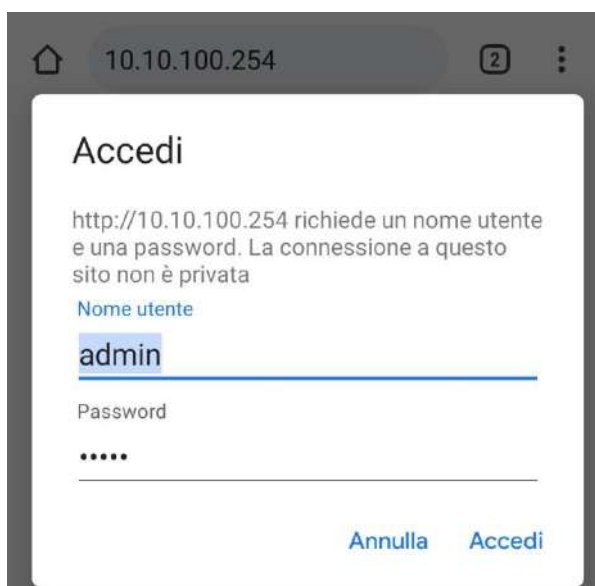
Figura 86 - Schermata di accesso al web server per la configurazione del datalogger
