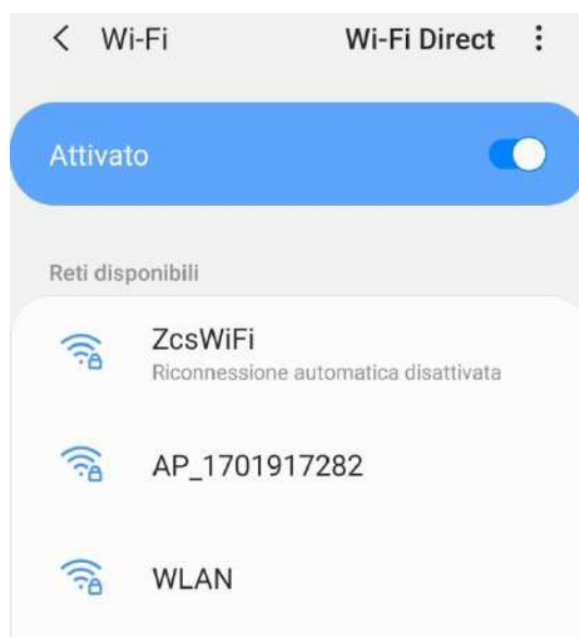
Figura 37 – Disattivazione della riconnessione automatica ad una rete
