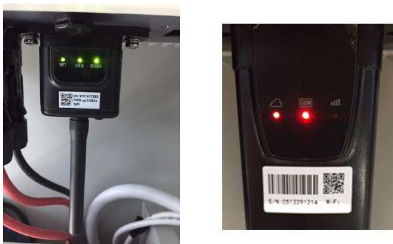
Figura 52 - Stato finale dei led
