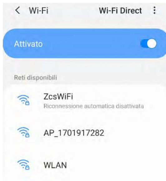
Figura 84 - Disattivazione della riconnessione automatica a una rete
