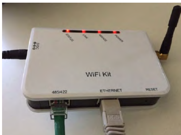
Figura 82 – Cavo Ethernet collegato al datalogger
