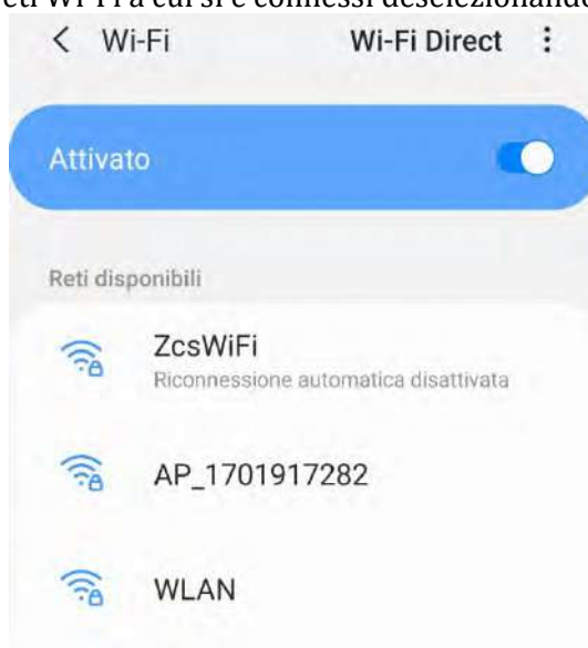
Figura 38 - Disattivazione della riconnessione automatica a una rete
